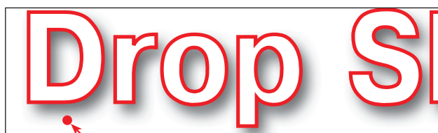
Рис. 3. Значения цвета тени «обрезаются» при печати на 3-х %. Край будет «резким».
